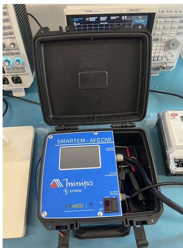
Figura 10 - Protótipo do Analisador de Fraudes Eletrônicas e Verificador Metrológico Integrado.
