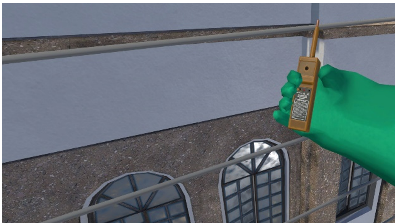
Figura 06: Teste virtual de tensão nas fases do circuito elétrico de baixa tensão.
