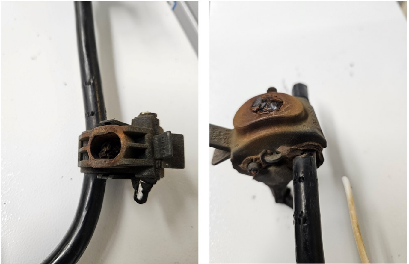
Figura 3 - Conectores retirados da rede multiplexada
