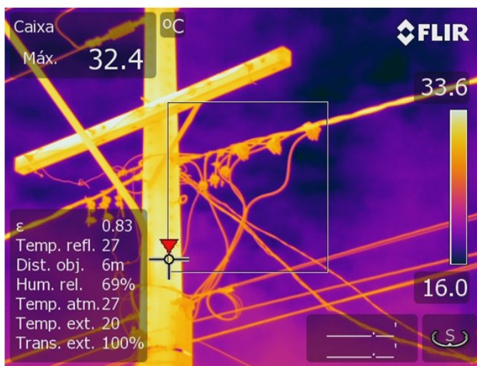
Figura 10 - Termografia nos conectores instalados.
