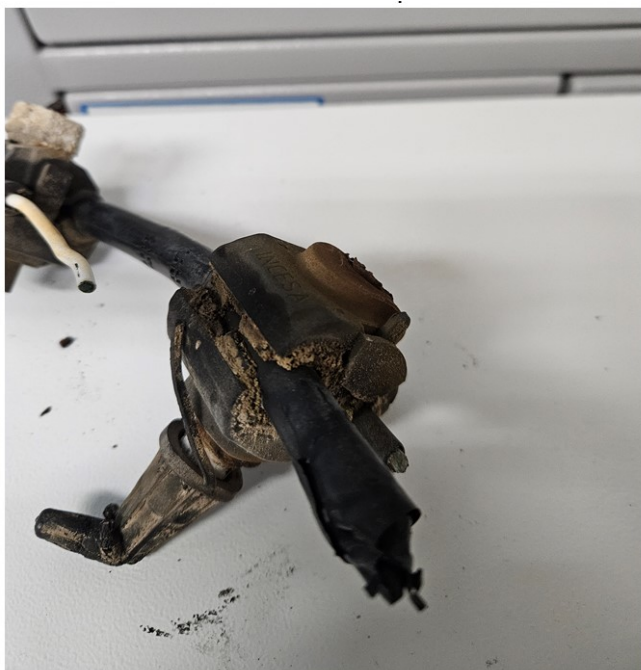
Figura 2 - Conector retirado da rede.
