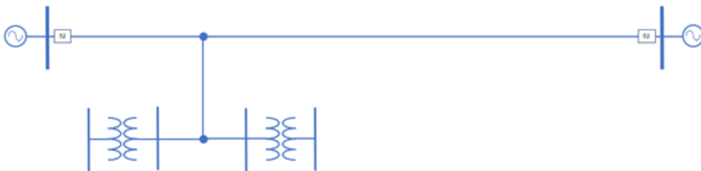
Figura 1 - Linha de distribuição com carga interna em derivação ou tape.
